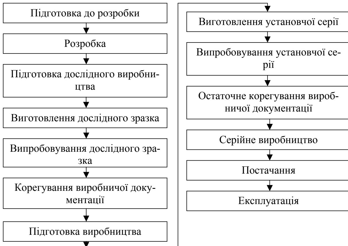
Рис. 10.1. Спрощена блок-схема алгоритму виконання етапів та стадій створення та використання ТС серійного виробництва
