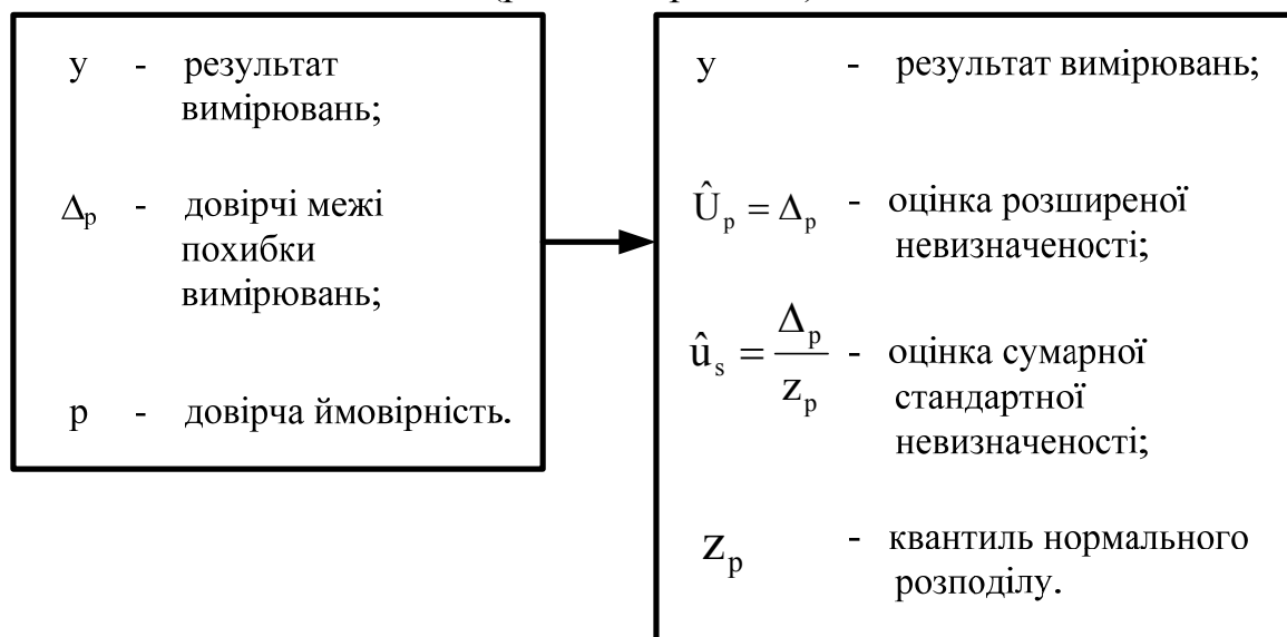
Рисунок 4.3 – Схема оцінювання невизначеності через довірчі межі похибки вимірювань
