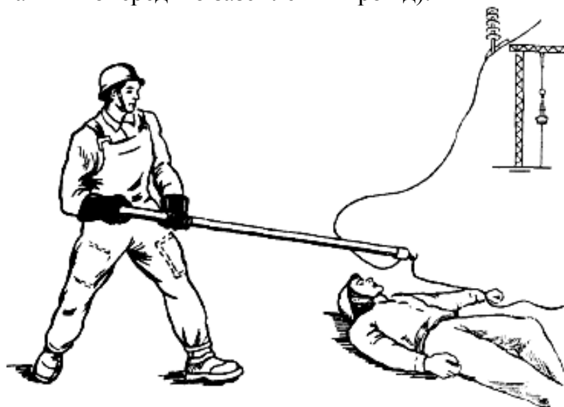
Рисунок 6.16 – Звільнення потерпілого від дії струму в електроустановках напругою понад 1000 В ізольовальною штангою
