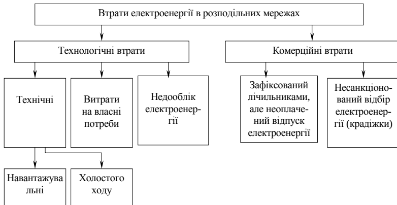
Рис. 1.1. Структура втрат у розподільних мережах
