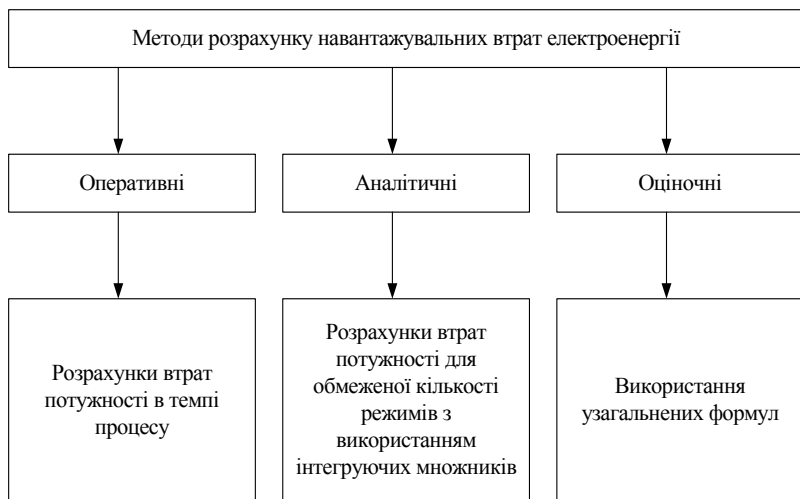
Рис. 1.2. Структура розрахунку втрат електроенергії
