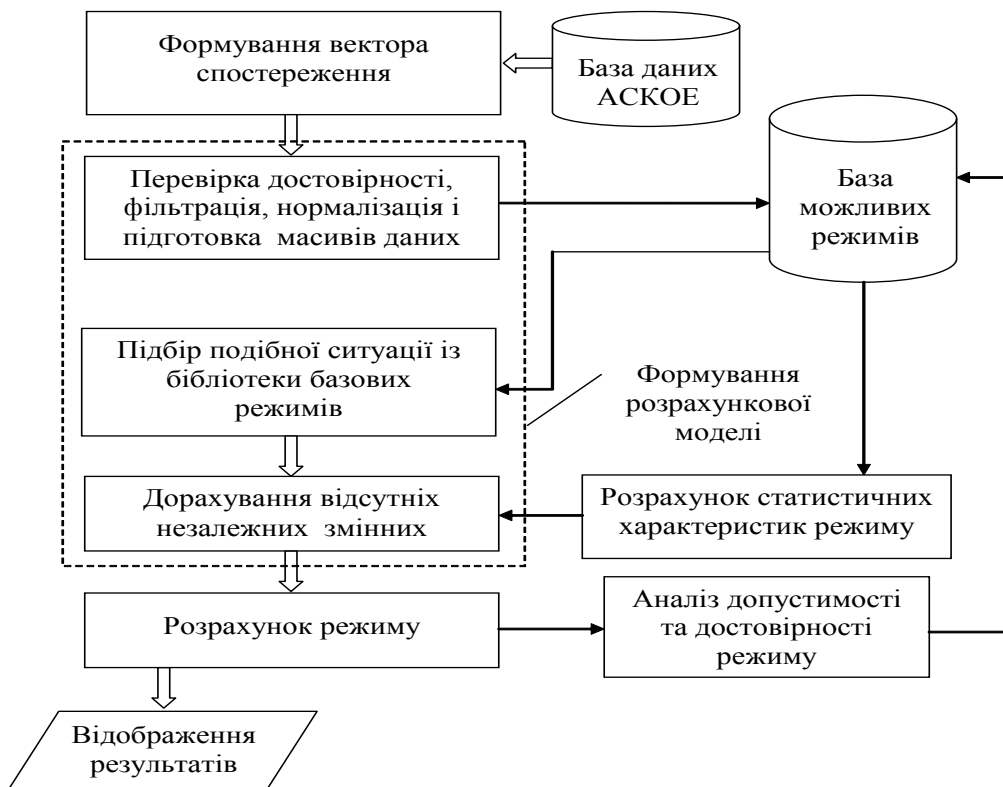
Рис. 3.1. Блок-схема алгоритму визначення параметрів поточного режиму
