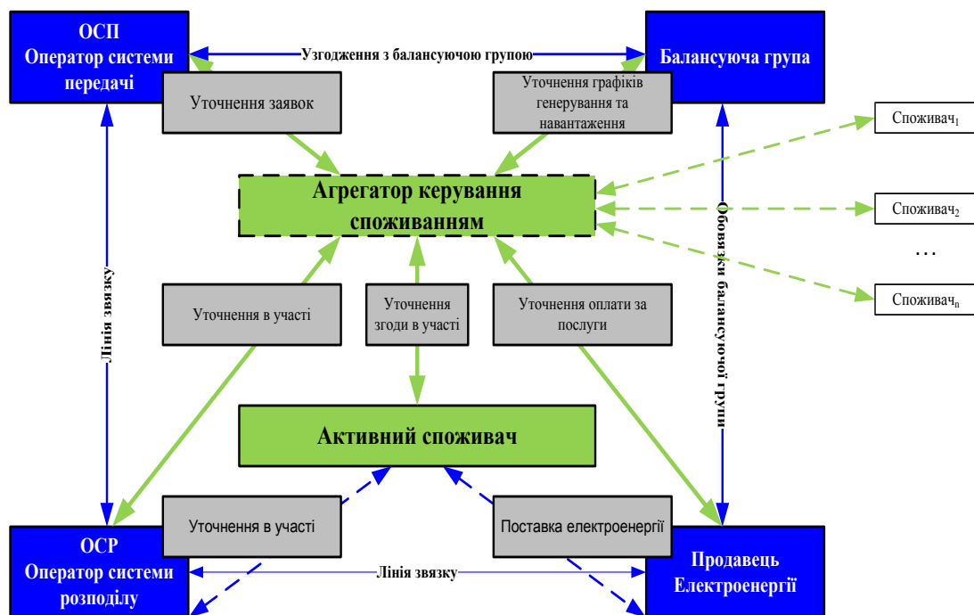
Рис. 4.18. Узагальнена схема принципів реалізації керування попитом
