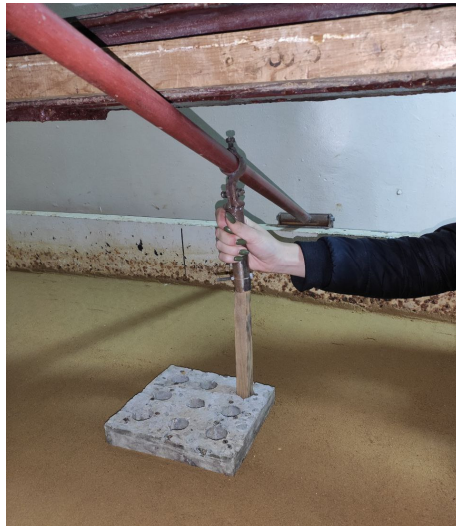
Рис. 2.35 – Вдавлювання паль за допомогою важільної системи
