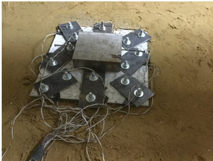
Рис. 2.9 – Ростверк з закріпленими в ньому палями та підколонином
