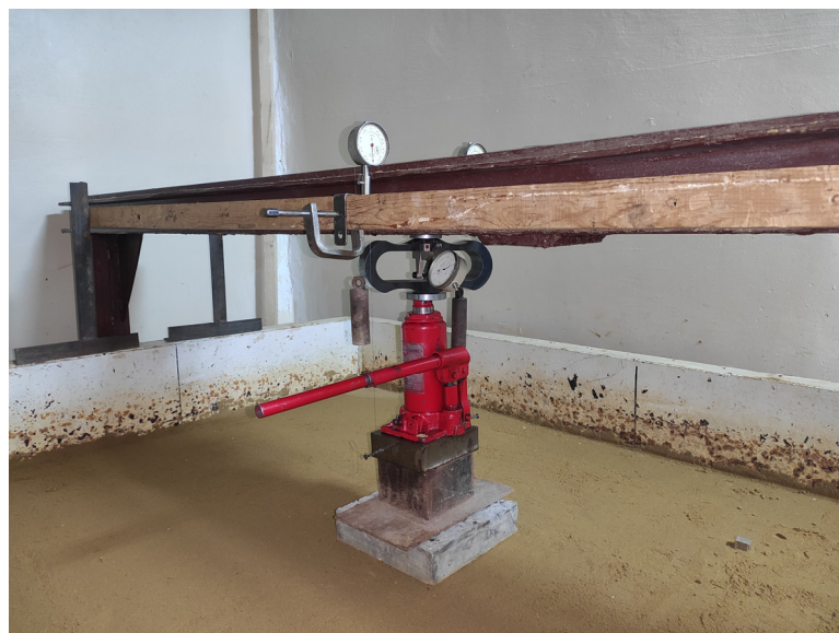
Рис. 2.38 – Модель випробування плити ростверку
