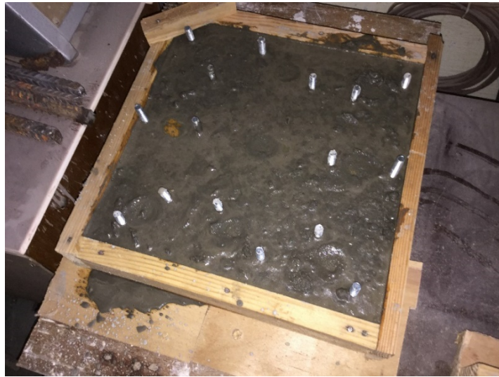
Рис. 2.8 – Система анкерних болтів для закріплення голів паль у ростверку
