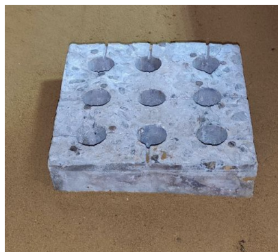
Рис. 2.34 – Модель ростверку 200×200 мм
