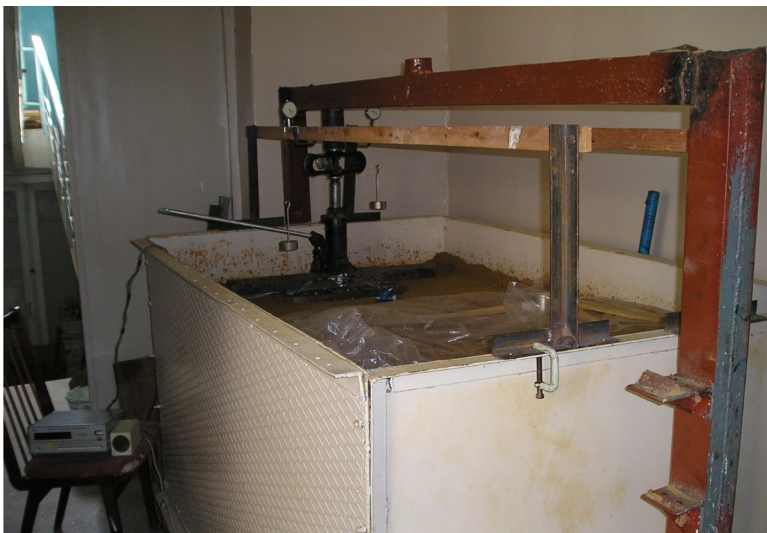
Рис. 2.5 – Проведення дослідів з навантаження моделі пального фундаменту
