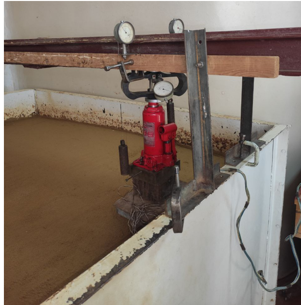
Рис. 2.37 – Модель пальового фундаменту перед випробуванням
