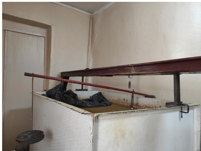
Рис. 2.39 – Випробування одиночної палі в лотку
