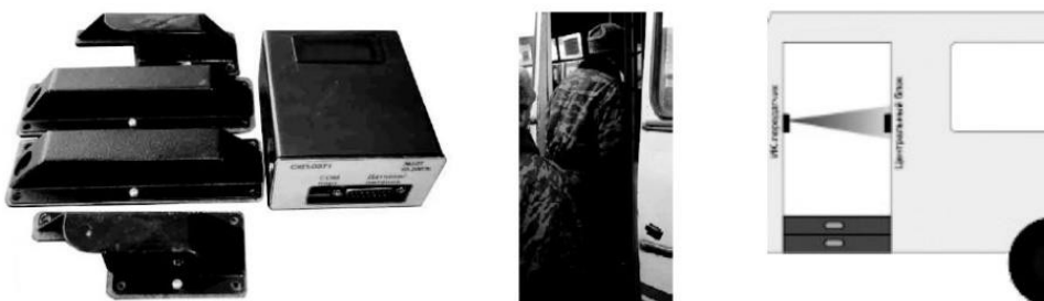
Рисунок 4.6 – Зовнішній вигляд інфрачервоних датчиків
