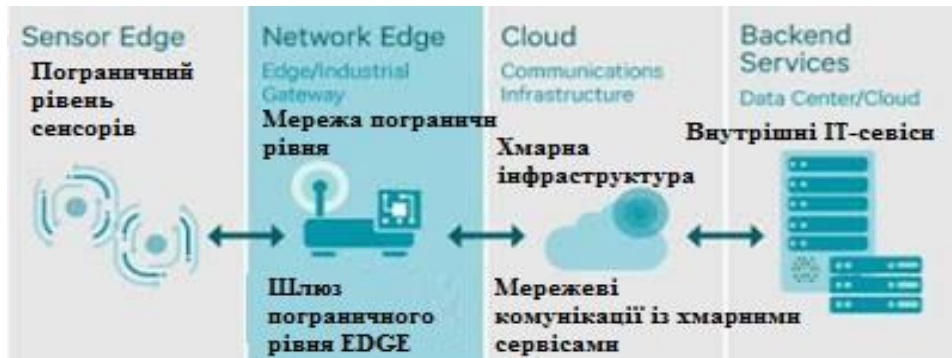
Рисунок 3.7 – Стикування пристроїв пограничного рівня в архітектурі IoT з іншими пристроями в промисловості і побуті
