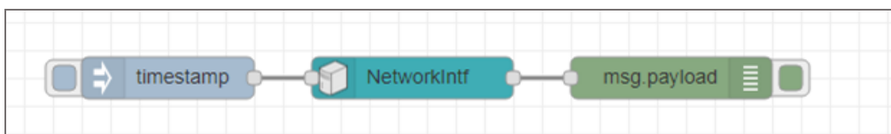
Рисунок Д.2 – Вигляд встановленого вузла типу NetworkIntf
