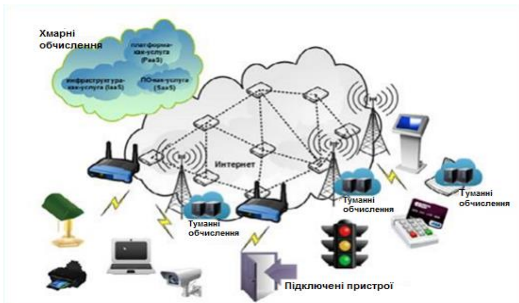
Рисунок 3.3 – Загальний вигляд складових Інтернету речей
