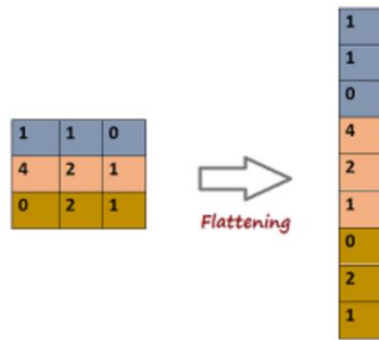
Рис. 6.13. Приклад застосування операції Flatten до результатів пар «Conv-Pooling» з Dropout [36]
