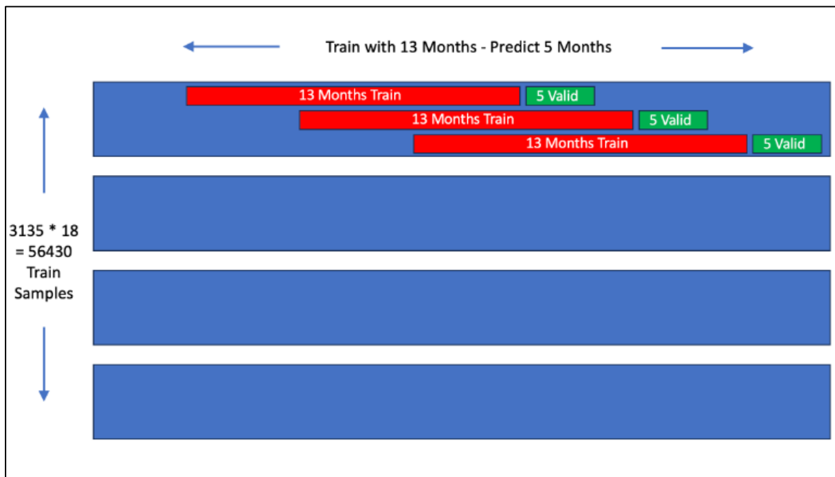
Рисунок 8.11– Створення 18 часових рядів для кожного округу. Використано 13 місяців для навчання GRU та передбачення наступних 5 місяців. Після цього доступно 56,000 часових рядів для тренування моделі. Рішення 3rd Place - Predict Multipliers with GRU
