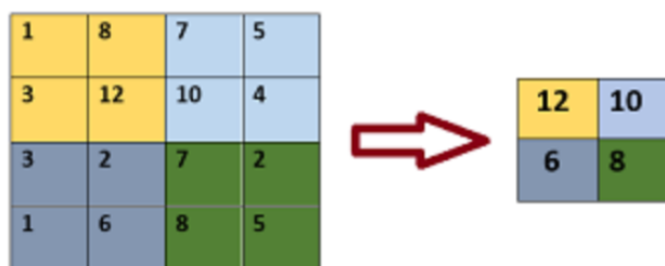
Рис. 6.12. Приклад застосування операції MaxPooling2D(pool_size=(2, 2), strides=None, padding="valid") до вхідного зображення [36]
