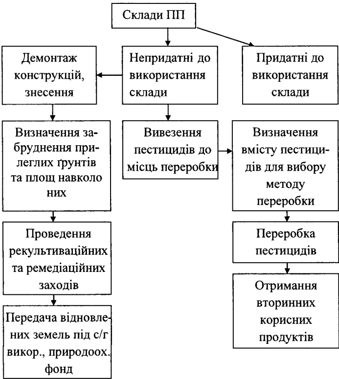
Рисунок 3.1 – Схема відновлення забруднених пестицидами земель та рекультивації територій
