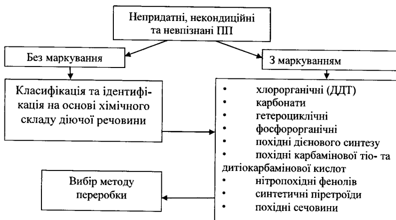
Рисунок 3.2 – Схема комплексної переробки пестицидів
