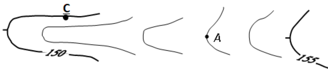
Рисунок 7.10 – Визначення позначки точки, яка лежить на горизонталі
