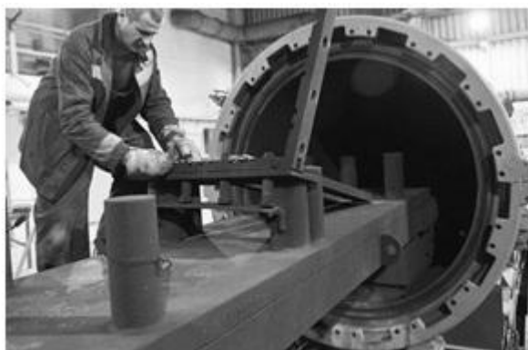
Рисунок 3.37 – Кутова схема зварювання вибухом до початку (а) і в стадії вибуху (б), а також загальний вигляд камери для зварювання (в)
