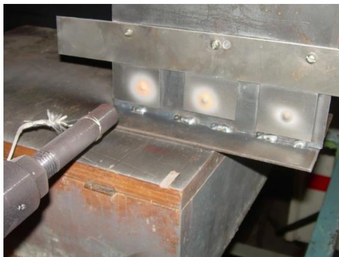
Рисунок 5.3 – Результати напилювання для дистанцій справа наліво 10 мм, 30 мм, 50 мм
