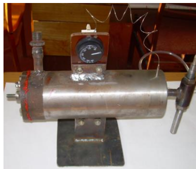
Рисунок 4.3 – Пристрій для газодинамічного нанесення покриттів
