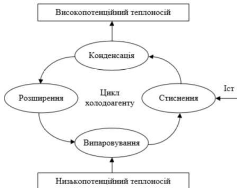
Рисунок 4.3 – Цикл парокомпресійного теплового насоса
