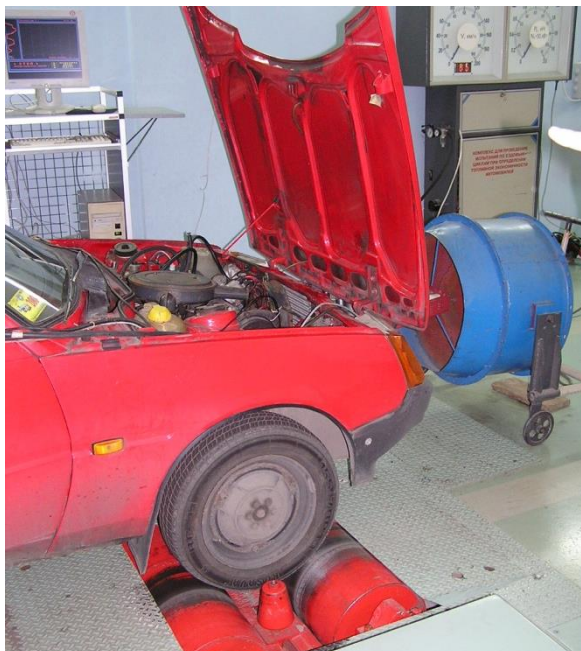
Рис. 2. Об'єкт експериментальних досліджень – автомобіль ЗАЗ-1102 «Таврія» на тяговому роликівому стенді
