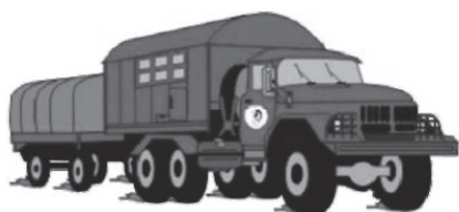
Фільтрувальна станція МАФС
