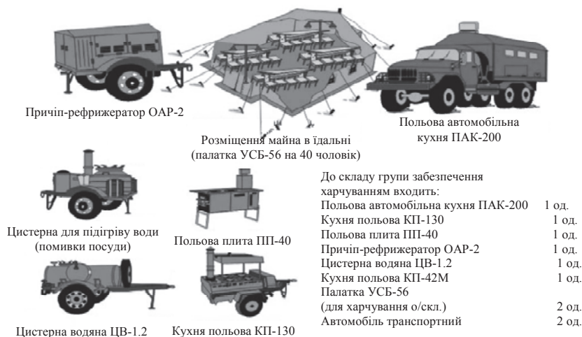
Рис. 6.8. Обладнання групи харчування
