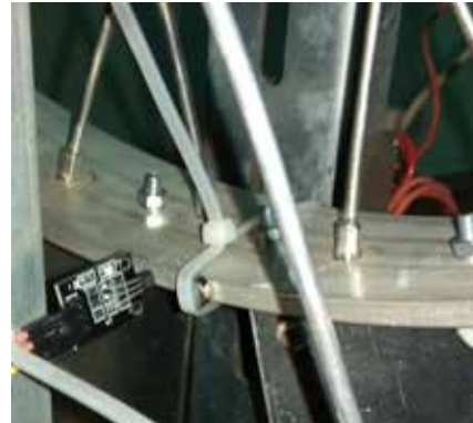
Рисунок 4 – Сенсор швидкості обертання вітроколеса
