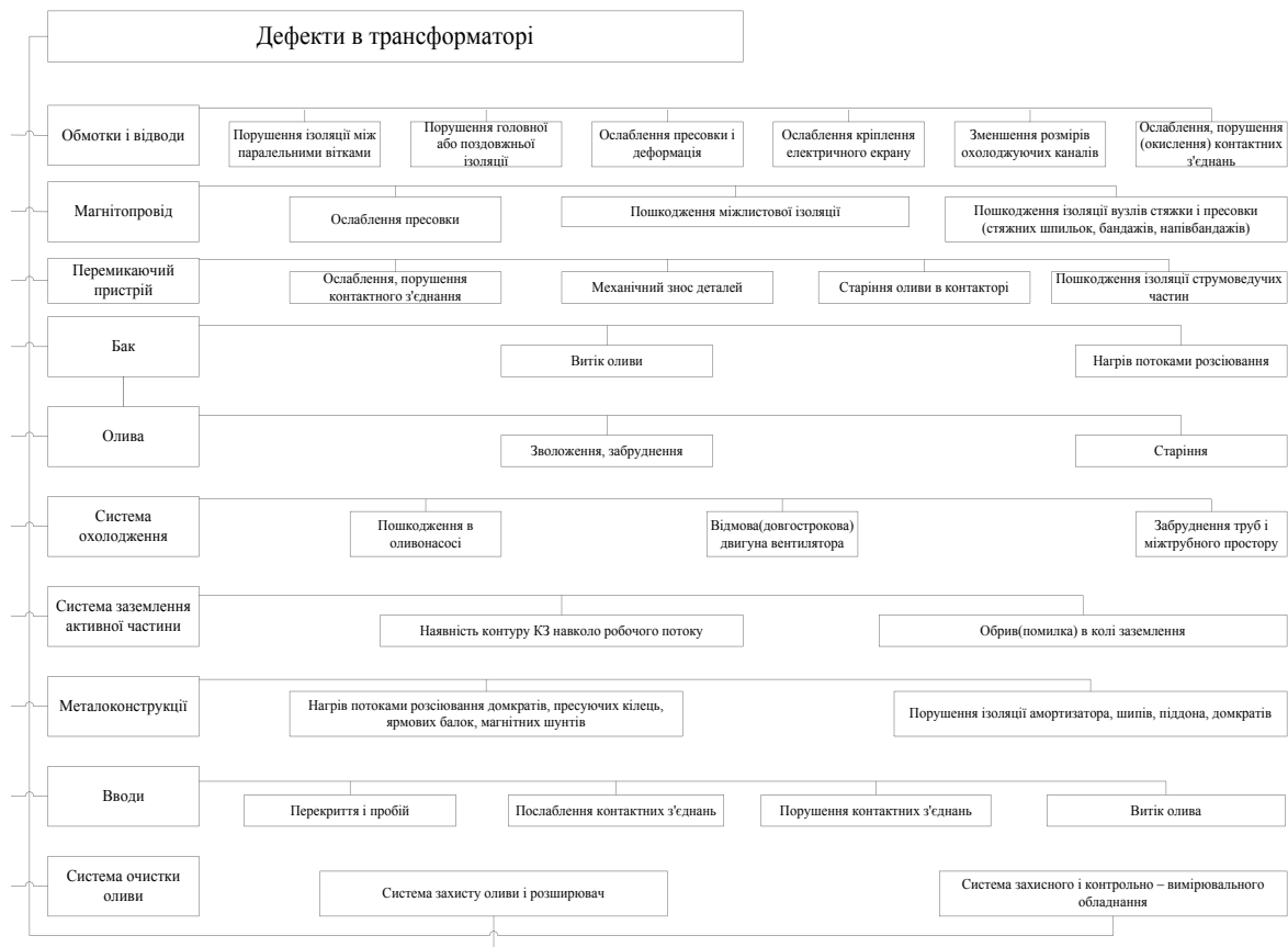
Рис.1 - Узагальнена система класифікації дефектів силових трансформаторів
