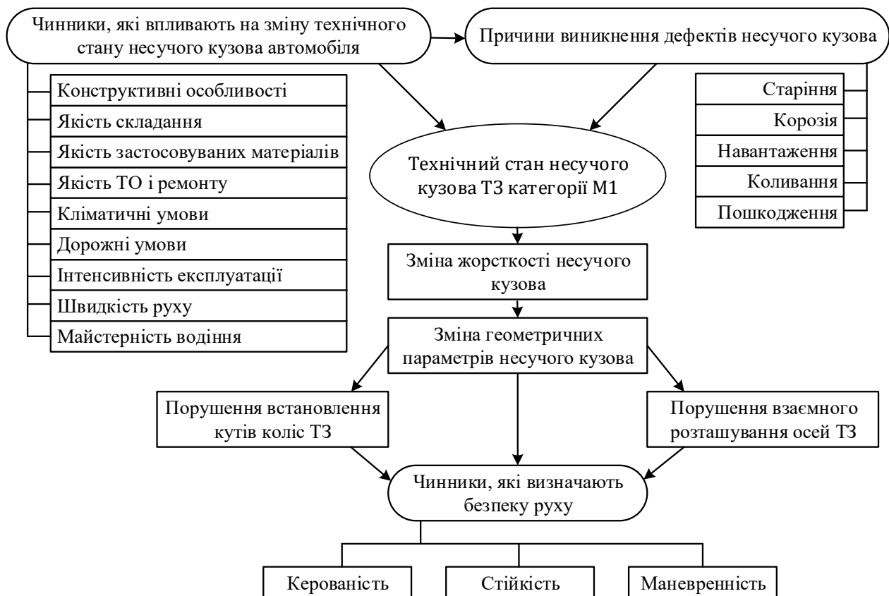
Рисунок 3 – Взаємозв'язок технічного стану несучого кузова з експлуатаційними властивостями автомобіля, які впливають на безпеку руху
