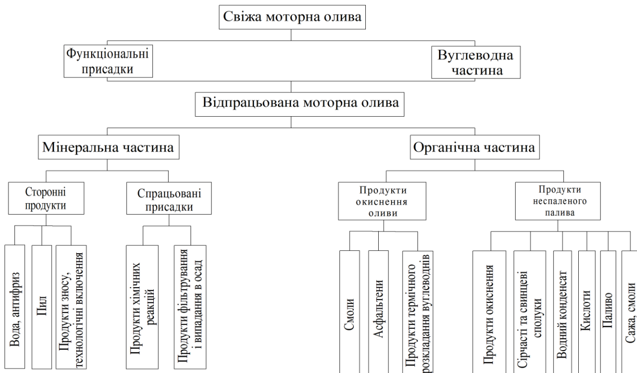
Рисунок 1 – Схема зміни складу моторної оливи з напрацюванням
