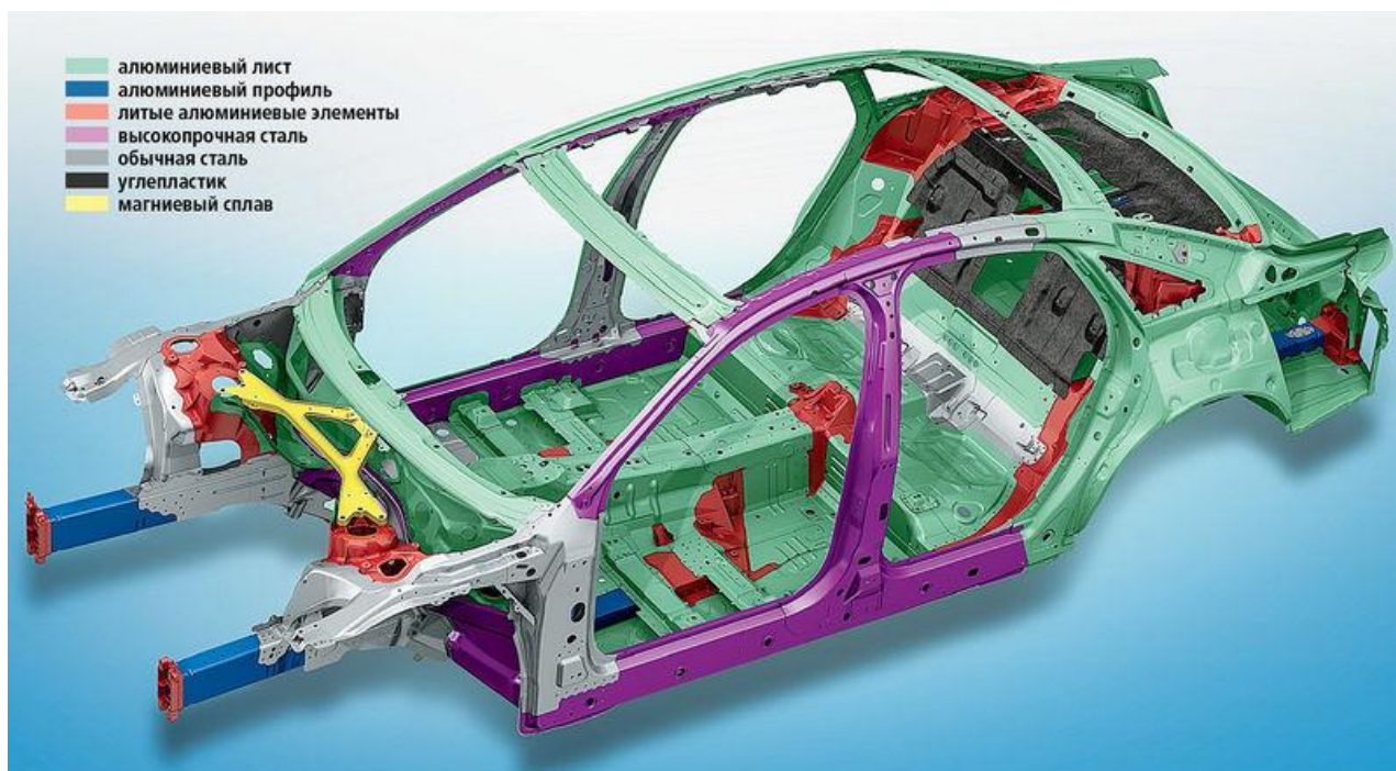
Рисунок 2 – Материалы, используемые при изготовлении кузова седана Audi A8 нового поколения [24]
