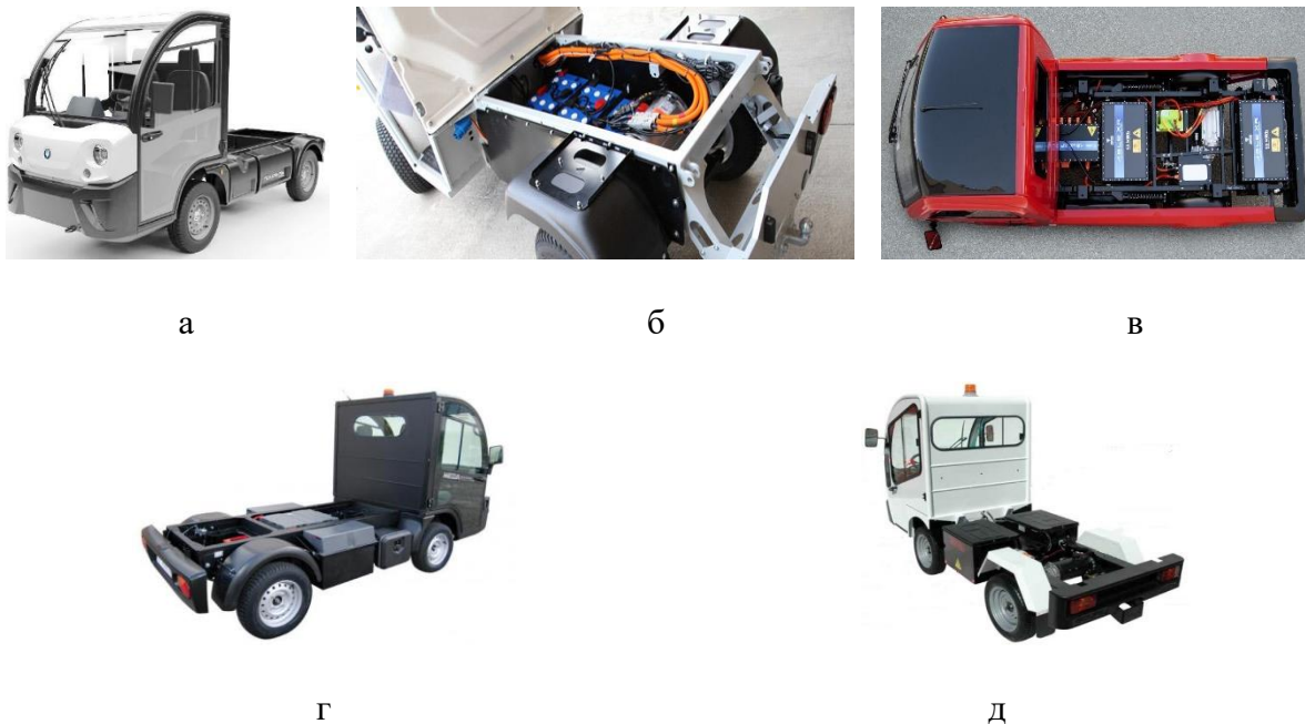
Рисунок 5 – Компонувальні схеми електромобілів за розміщенням блоків тягових АКБ: а – "bsF" ; б і в – "biF"; г – "bsoF"; д – "bsiF"
