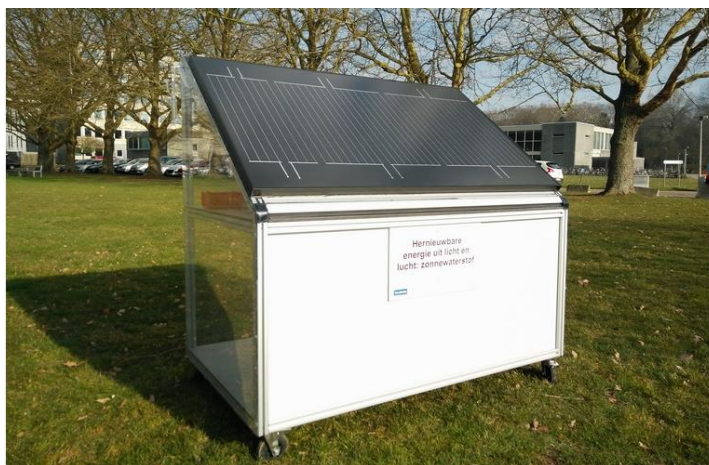
Рис. 5. Сонячна панель розщеплює воду для виробництва водню [59].
