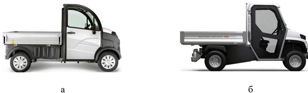
Рисунок 1 – Електромобілі, створені за компоувальною схемою "CbA": а) – модельного ряду "Aixam e-truck"; б) – модельного ряду "Alke ATX"
