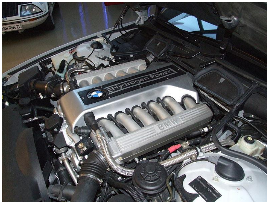
Рисунок 7 – 12-циліндровий двигун BMW Hydrogen 7 об'ємом 6 літрів [58]
