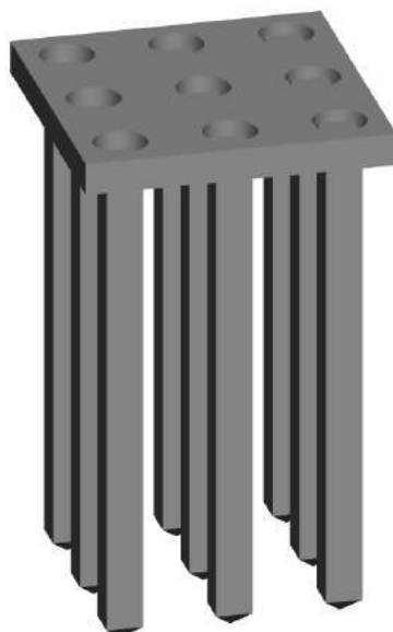
Рис. 1 – Об'ємне зображення моделі пального фундаменту при кроці паль 3d
