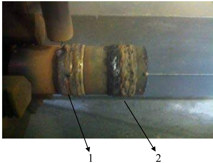
Рис. 1 - Наплавлені валки дротом 30ХГСА (позиція 1) та валки з обмашенням на основі феррованадію наплавлені дротом 30ХГСА (позиція 2)
