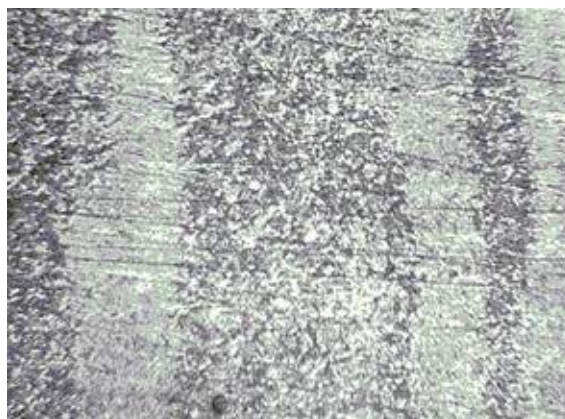
Рис. 3. Мікроструктури зміцнених поверхонь при швидкості переміщення електроду 11 м/год (x300)
