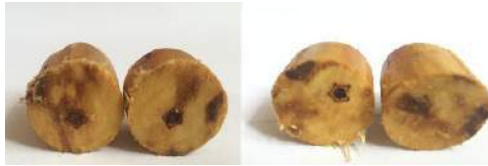
Рисунок 2 – Поперечний розріз зразків насичених імпульсним способом
