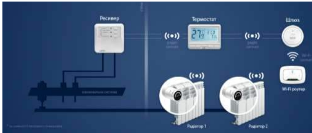
Рис. 2. Автоматизована система управління централізованим опаленням
