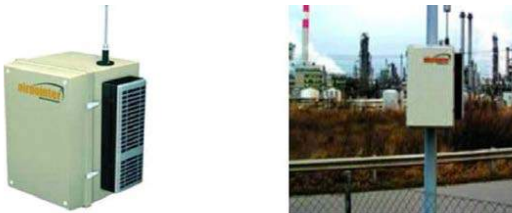
Рис. 1 Станція «Airpointer»: а) загальний вигляд; б) розміщення на опорі
