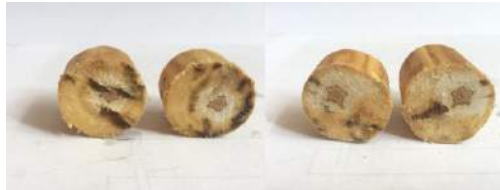
Рисунок 1 – Поперечний розріз зразків насичених статичним способом
