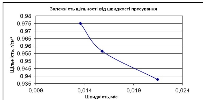
Рис. 4. Залежність щільності брикету від швидкості пресування
