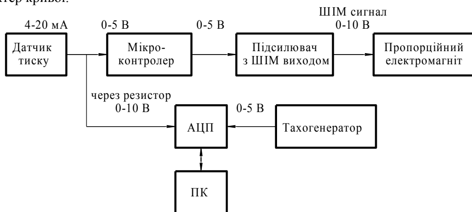
Рис. 1 Структурна схема системи керування зі зворотним зв'язком та реєстрації даних
