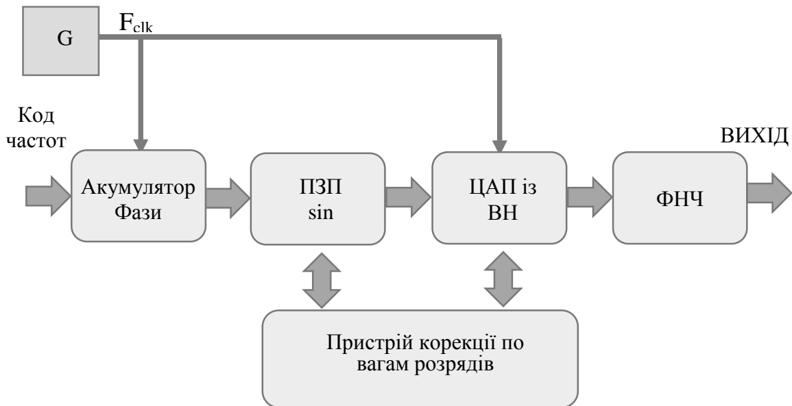
Рисунок – Структура DDS-генератора з використанням ЦАП з ваговою надлишковістю
