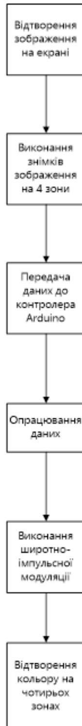
Рисунок 1 – Схема роботи «SmartLight»
