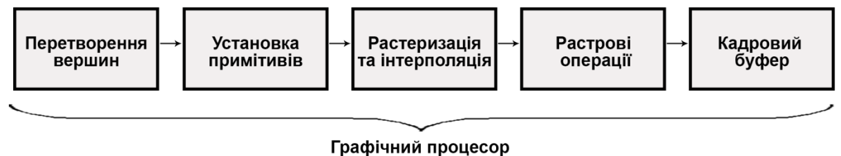
Рисунок 3 - 3D конвеєр відеокарт другого покоління
