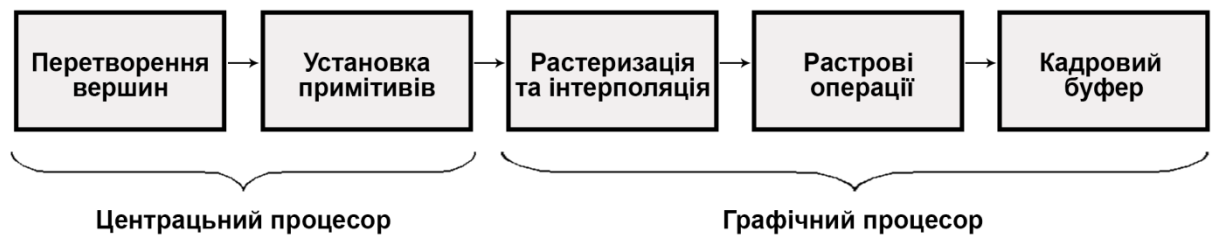
Рисунок 2 - 3D конвеєр відеокарт першого покоління
