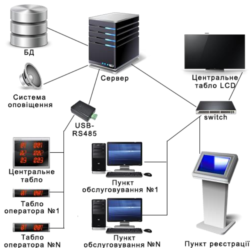
Рисунок 1 – Схема режимів роботи електронної черги
