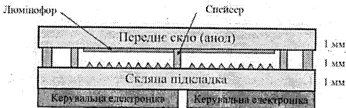
Рисунок 7.9 – Конструкція типового дисплея на польовій емісії (FED)
