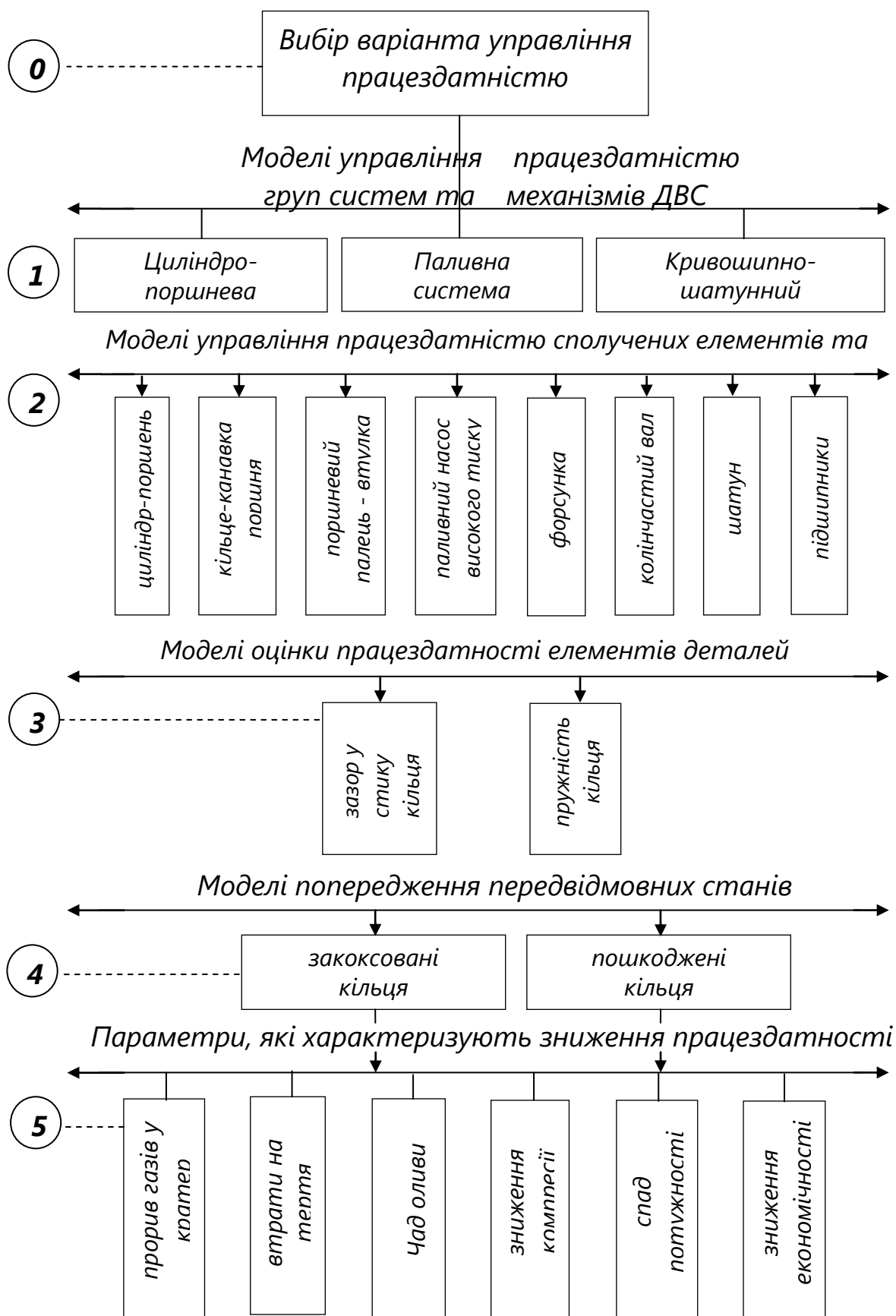
Рисунок 6.1 – Ієрархічна схема процесу розробки системи управління працездатністю двигуна
