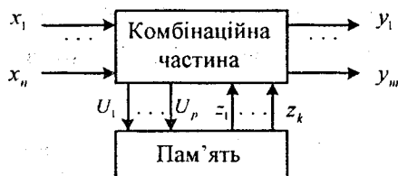
Рисунок 2.17 — Структура складного релейного пристрою
