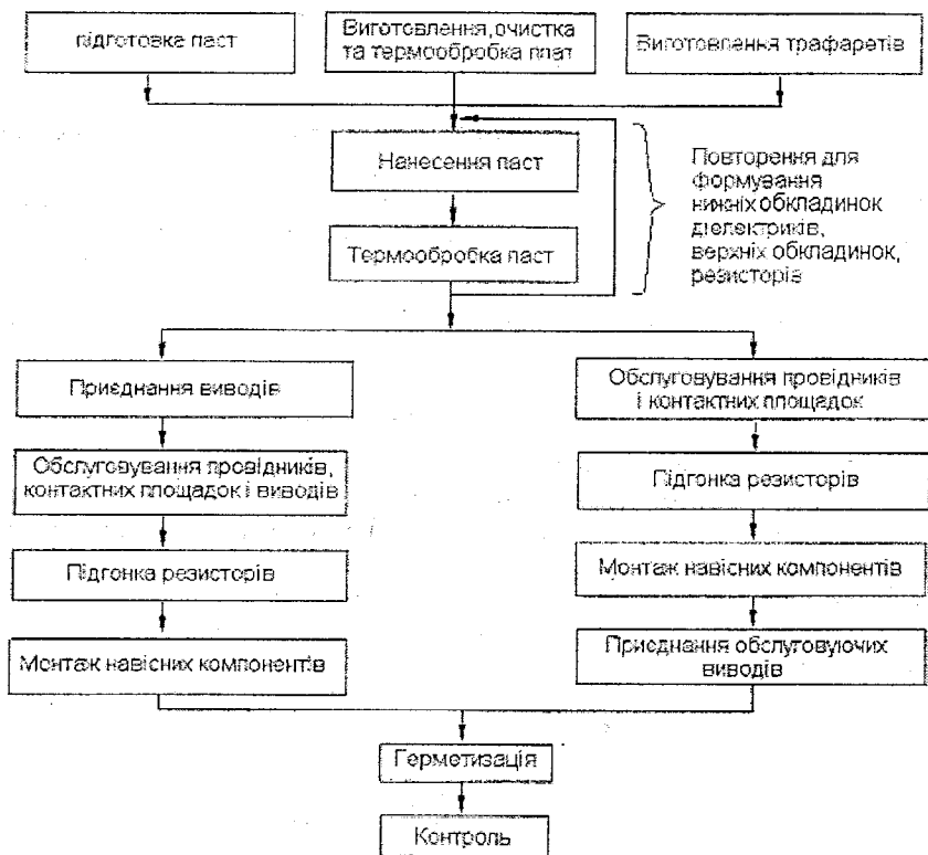
Рисунок 3.7 – Структурна схема технологічного процесу виготовлення товстоплівкових ГІС
