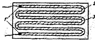
Рисунок 4.3 – Тензодатчик: 1 – виводи; 2 – основа; 3 – фольга
