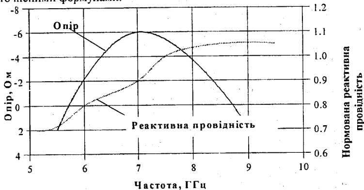
Рисунок 24 - Залежність опору і нормованої реактивної провідності від частоти для структури в режимі інжекційно-пролітного ефекту
