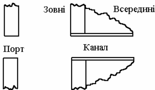
Рисунок 4.2 – Приклади розміщення фазоінверторів
