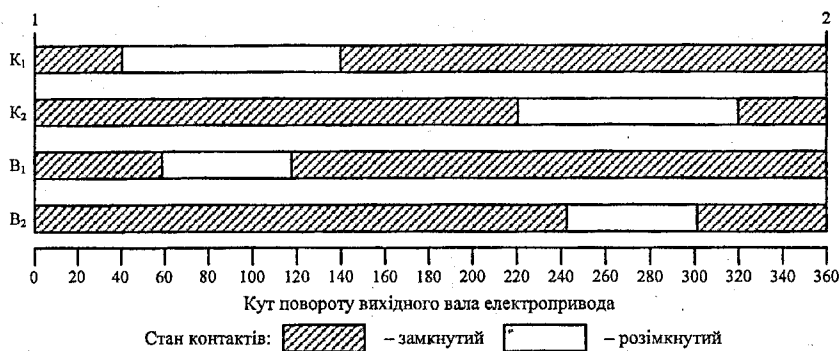
Рисунок 4.5 – Кутова діаграма роботи реакторного пристрою РПН 1, 2 – номери положень; B_1, B_2, K_1, K_2 – діаграми стану контактів (позначення – на рис. 4.4)
