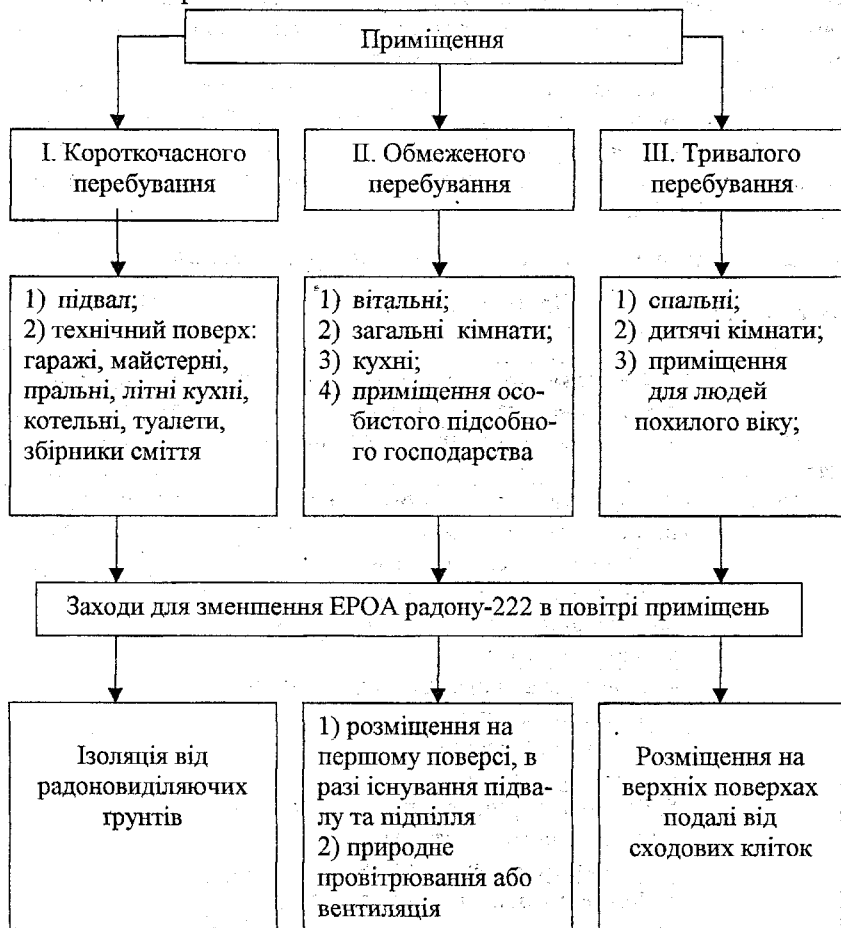
Рисунок 6.6 - Класифікація приміщень за режимом використання людиною та імовірністю накопичення радону і відповідні заходи для зменшення ЕРОА радону-222
