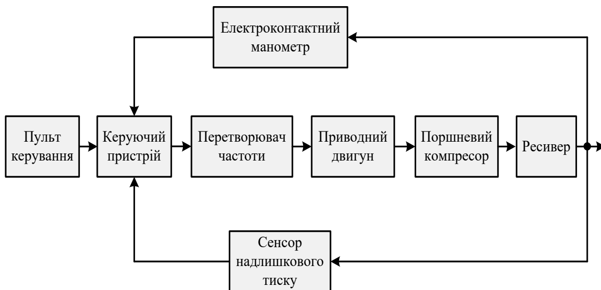
Рисунок 5.7 – Структурна схема системи автоматичного регулювання тиску
