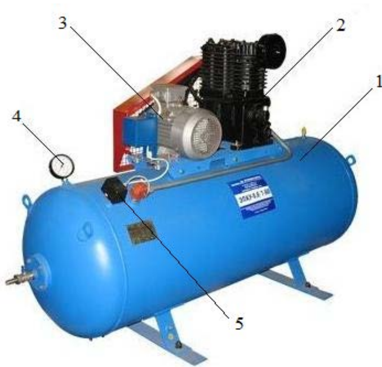
Рисунок 5.4 – Зовнішній вигляд компресорної установки:
