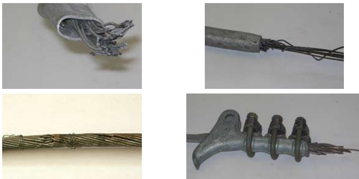
Рисунок 4.4 – Проводи, пошкоджені через вібрацію
