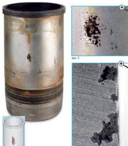
Рисунок 11.1 – Дефекти гільзи блока циліндрів
