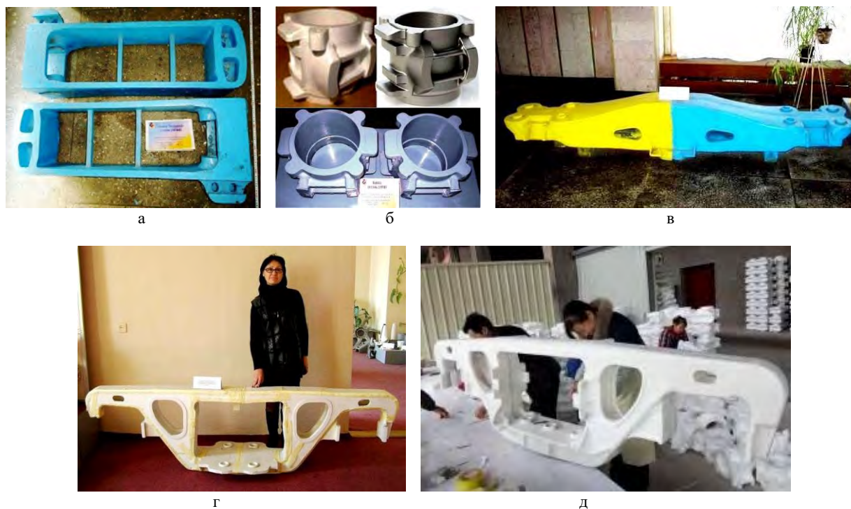
Рис. 2. Приклади виготовлення таких вагонних виливків: а - хомут тягловий; б - бруска (модель та виливки у двох видах); в - надресорна балка; а також г, д - моделі бічної рами
