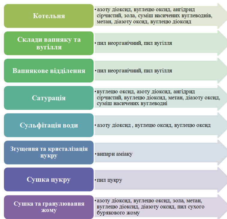
Рис. 3. Джерела забруднення атмосферного повітря
