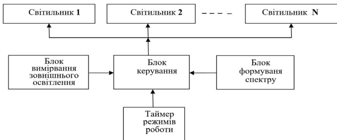
Рис. 1. Структурна схеми автоматизованої системи штучного освітлення рослин.
