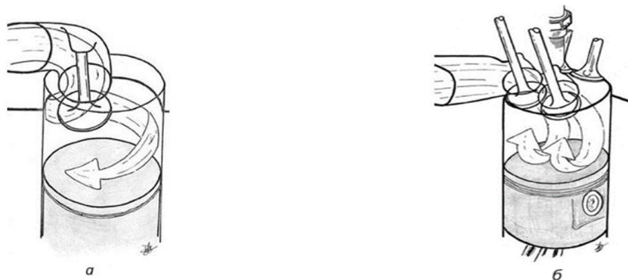
Рисунок 1 – Ефекти при доопрацюванні каналів ГБЦ: а) Завихрення (Swirl); б) Утрамбування (Tumble)
