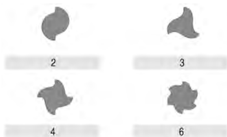
Рис. 1 – Перерізи кінцевих фрез із вказаною кількістю зубів
