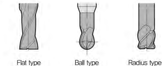
Рис. 2 – Типи виконання ріжучої частини фрез
