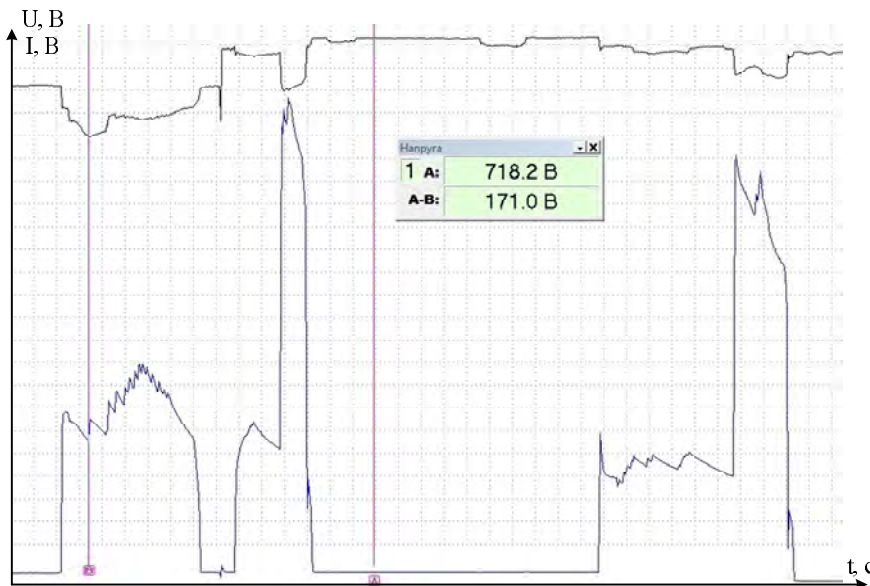
Рис. 2. Приклад осцилограми зміни навантаження та випрямленої напруги ТП
