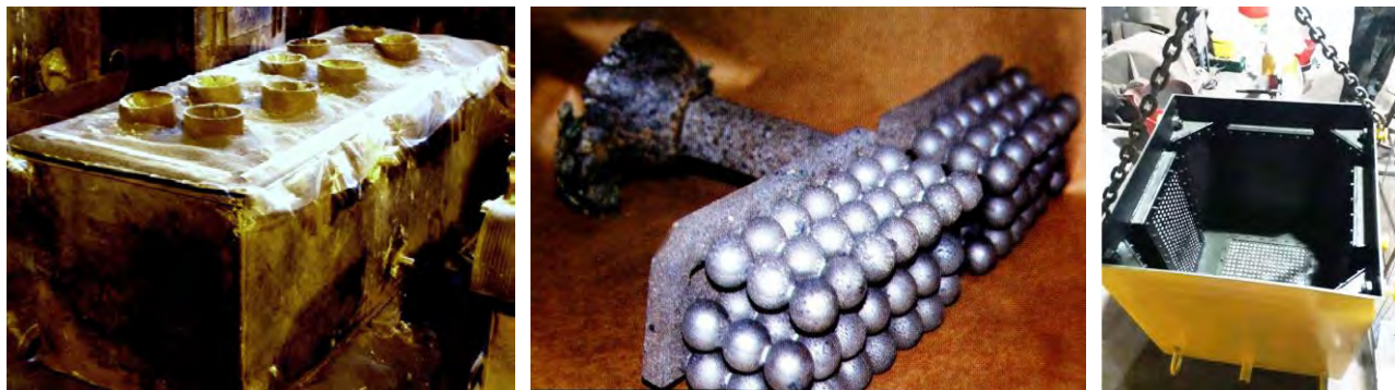
Рис. 2. Ливарна форма з кількома кластерами, виліті кулі для млина, контейнерна опока з внутрішніми фільтрами
