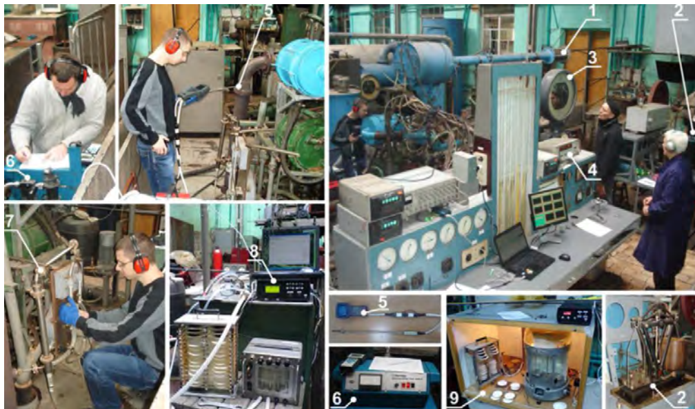
Рис. 1. Загальний вигляд випробувального стенду дизеля 4CH12/14 з універсальною системою екологічної діагностики:
