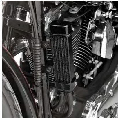
Рисунок 3 – Система охолодження оливи
