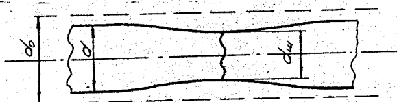
Рис.2.11. Зона утворення "шийки" при розтягу зразка із пластичного матеріалу
