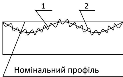
Рисунок 2.5 – Макровідхилення поверхні деталі від номінального профілю
