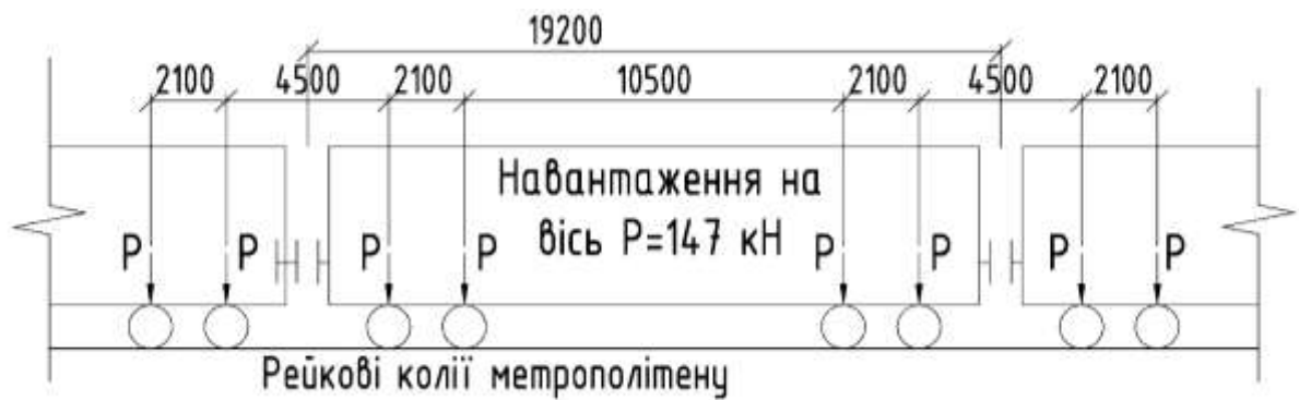
Рисунок 3.4 – Модель тимчасового навантаження потягу метрополітену
