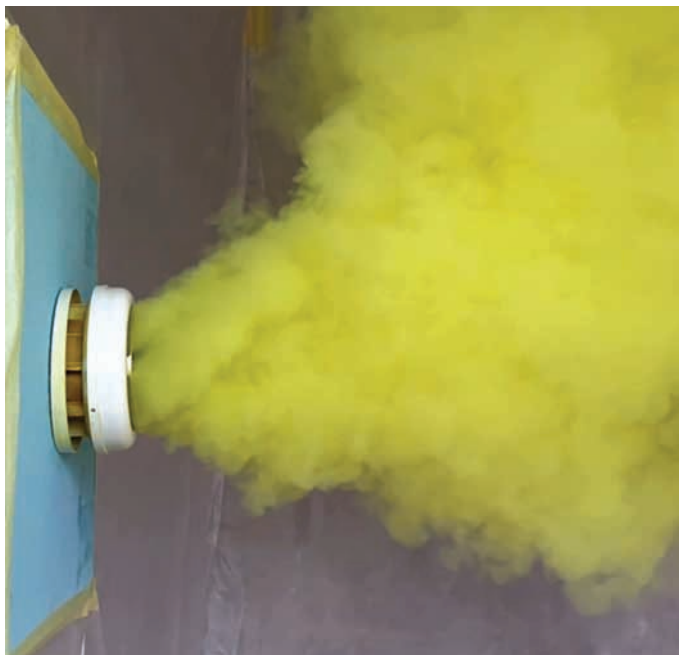
Рис. 6. Візуалізація повітряного потоку припливного повітря
