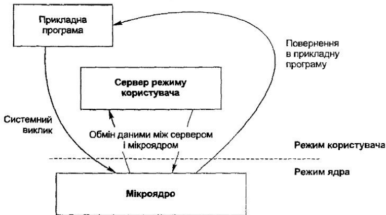
Рис. 2.1. Виконання системного виклику в архітектурі з мікроядром
