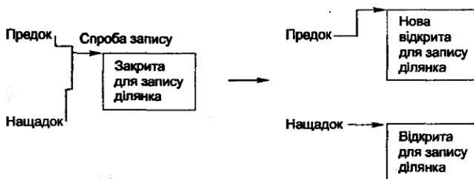
Рис. 3.5. Копіювання під час запису: пам'ять після спроби запису в неї
