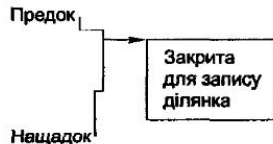
Рис. 3.4. Копіювання під час запису: пам'ять відразу після створення процесу
