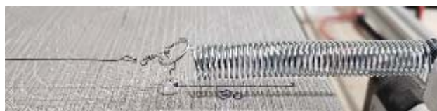
Рис. 1 Забезпечення натягу дроту за допомогою пружини
