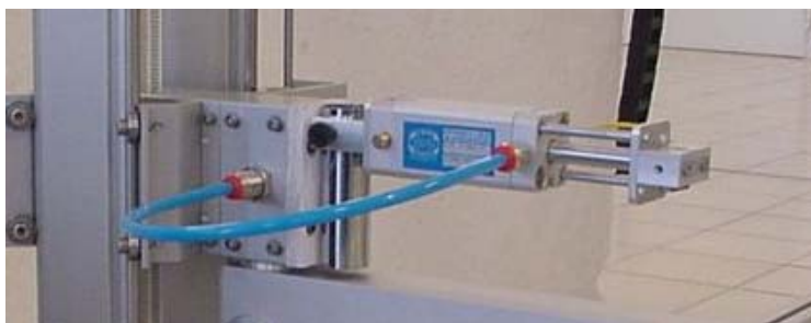
Рис. 2 Забезпечення натягу дроту за допомогою пневматичної системи
