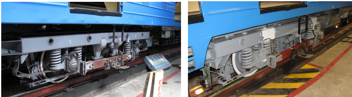
Рис. 1. Візки вагону метрополітену: а – повідцевий, б - шпінтонний
