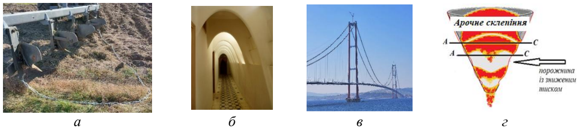
Рис.1. Приклади зрівноважених контурів, описуваних ланцюговою лінією, або її конформним відображенням: а – гнучкий робочий орган ґрунтопоглиблювача до плуга ПЛН-5-35; б – “аркада Гауді”, як конформне відображення катенарії; в – конструкція підвісного мосту; г – статичне арокне склепіння, утворене в рухомому масиві сипкого матеріалу в полі гравітаційних сил
