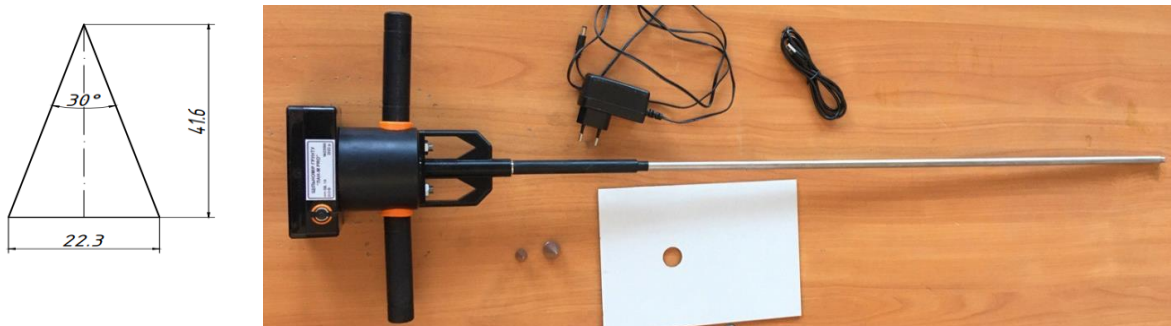
Рис.1. Пьезоелектричний пенетрометр з конусним наконечником під вимоги НАТО
