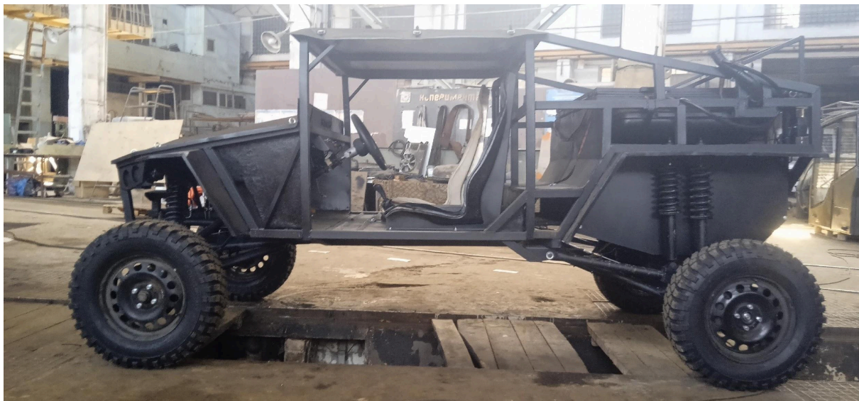
Рис.1 – Базова модель військового баггі LTV 02 «Мамай» під забудову гібридного приводу.
