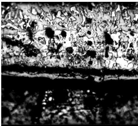
Рис. 1. Мікроструктура дифузійного шару на сталі У 10 з попереднім Ni–Co–P покриттям. Режими: T=1050^{\circ}\text{C} , витримка \tau=7 год. (ізотермічна витримка \tau=1 год. при T=800^{\circ}\text{C} ).
