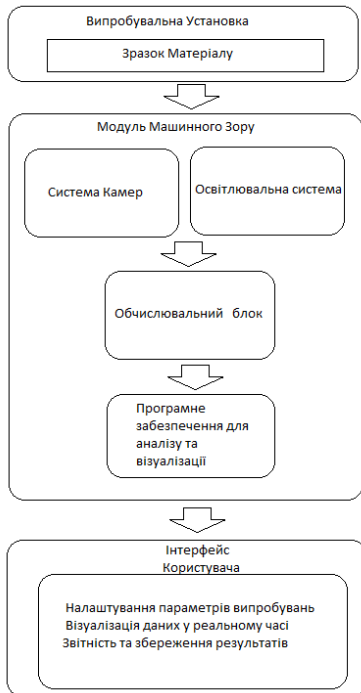
Рис. 1. Принципова функціональна схема вимірювальної системи на базі машинного зору для дослідження імпульсних навантажень на випробувальних машинах
