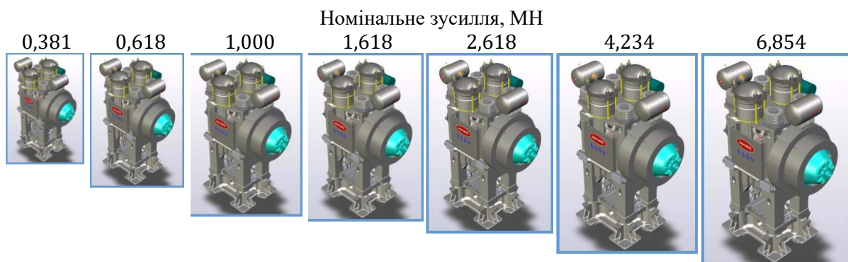
Рис. 3. Розмірний ряд пресів з клиношарнірним механізмом з увігнутим клином для розділення сортового прокату (розширення R_6 )
