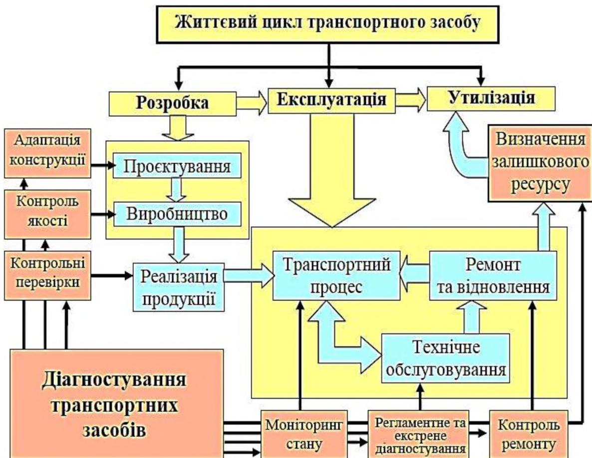
Рисунок 1.10 – Структура системи діагностування в життєвому циклі транспортного засобу
