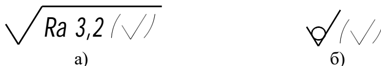
Рисунок 11.3 – Знаки шорсткості, що ставлять в правому верхньому куті
