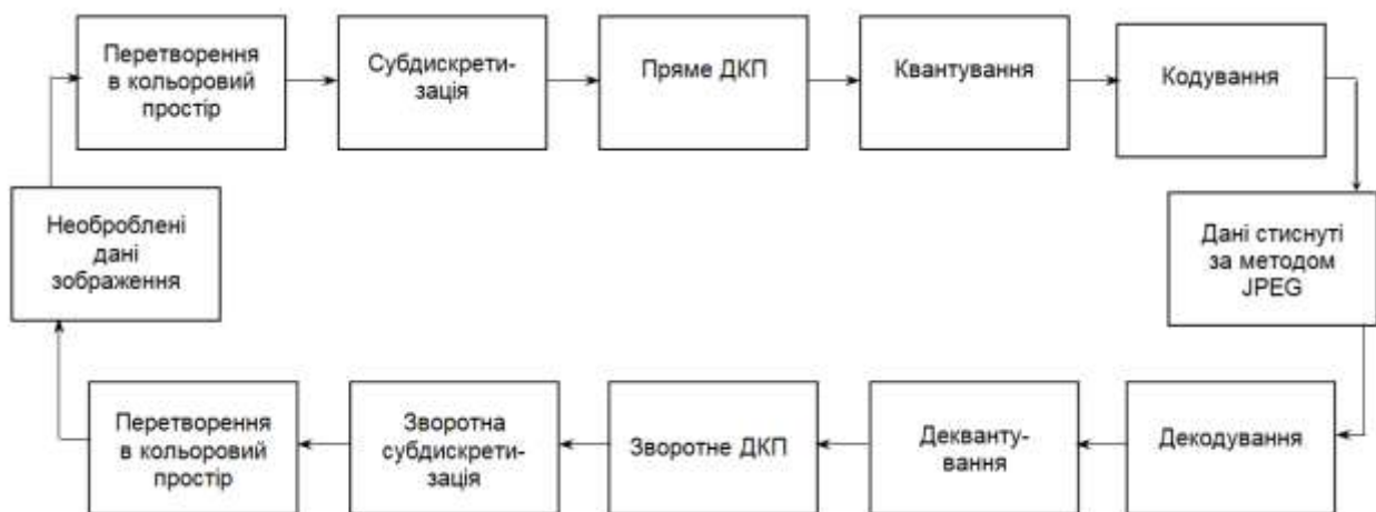
Рисунок 3.1 – Послідовність операцій в процесі стиснення зображень за методом JPEG
