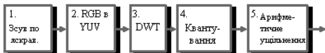
Рисунок 4.17 – Базова схема JPEG 2000
