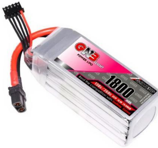
Рисунок 2.31 – Li-Po акумулятор Gaoneng GNB 1800mAh 4S 130C
