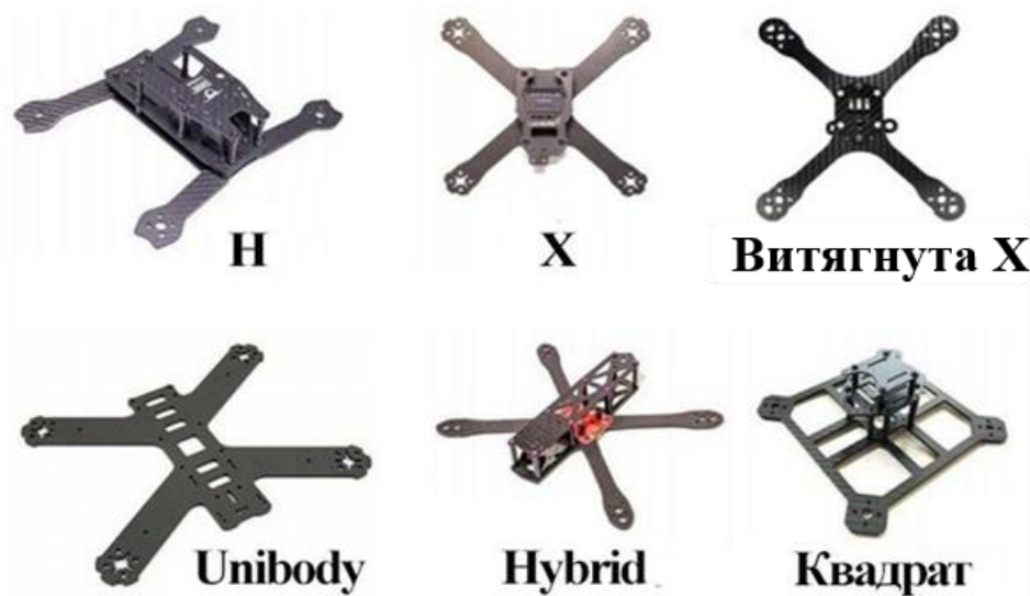
Рисунок 2.10 – Види рами FPV-дрону
