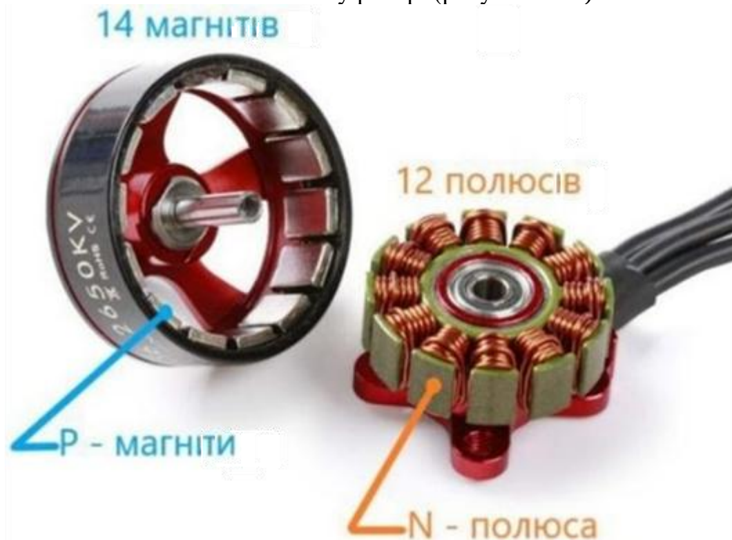
Рисунок 2.15 – Безколекторний двигун у розборі
