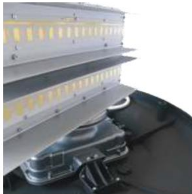
Рисунок 16.7 – Решітка патч-антени морського навігаційного радара FMCW у діапазоні X
