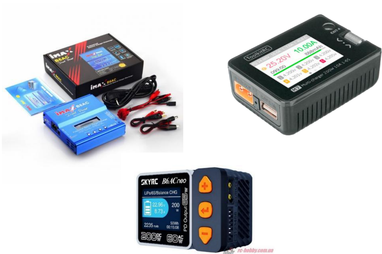
Рисунок 2.32 – Деякі типи пристроїв для заряджання акумуляторів
