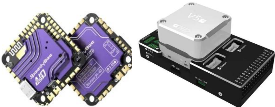
Рисунок 2.23 – Види польотних контролерів: а) – ПК FPV-дрону; б) – автопілот БПЛА
