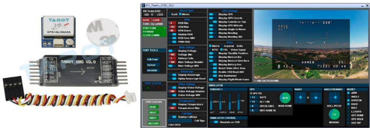
Рисунок 2.26 – Зовнішній вигляд плати OSD та відображення телеметрії на відео
