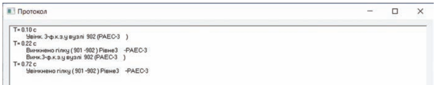
Рис. 1. Протокол перехідного процесу тривалість \Delta t_{K3}=0,12 с з успішним АПВ, T_f=7,1 с
