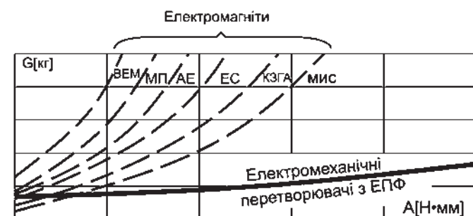
Рис. 3. Енергетичні характеристики приводів та матеріалу з ЕПФ
