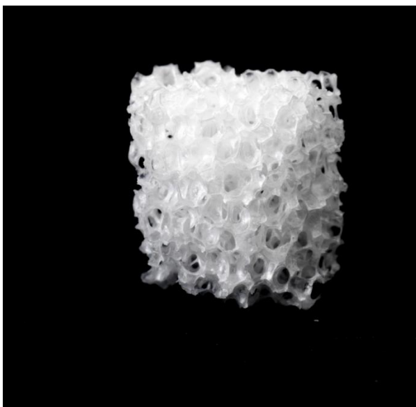
Рис. 1. Пориста біокерамічна гранула
