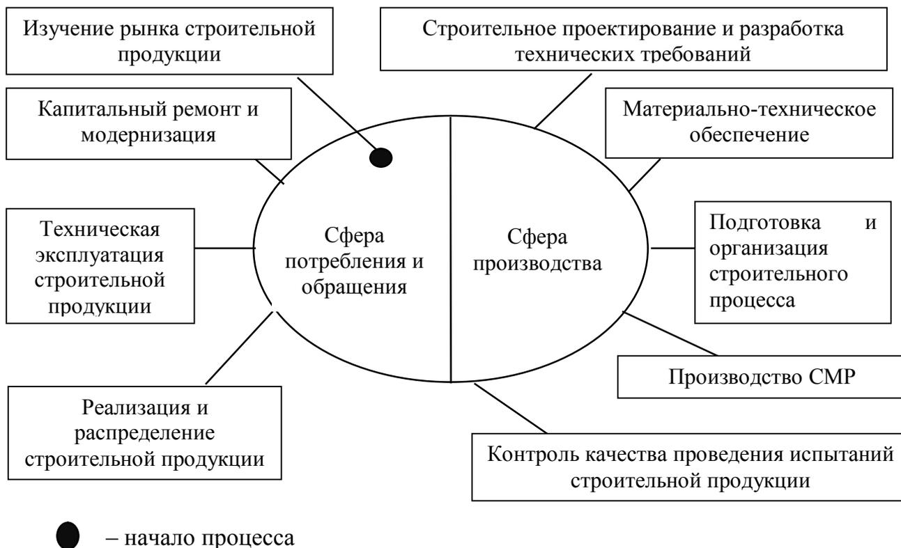
**Рис. 10.1.** "Петля качества" строительной продукции
