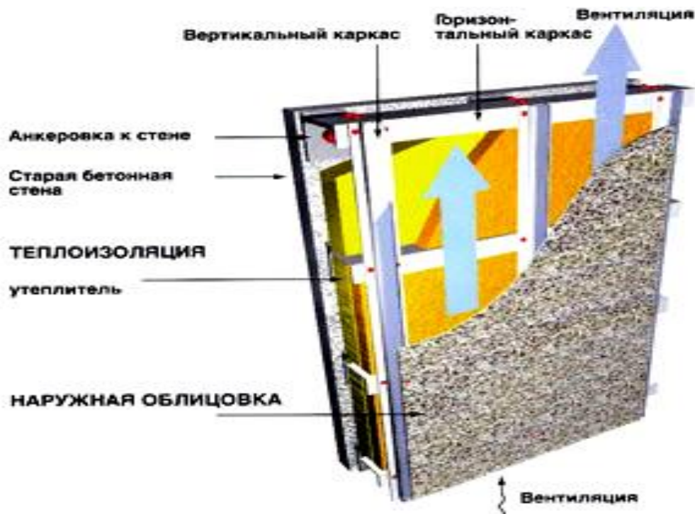
Рис. 14.2. – Конструкция вентилируемого фасада
