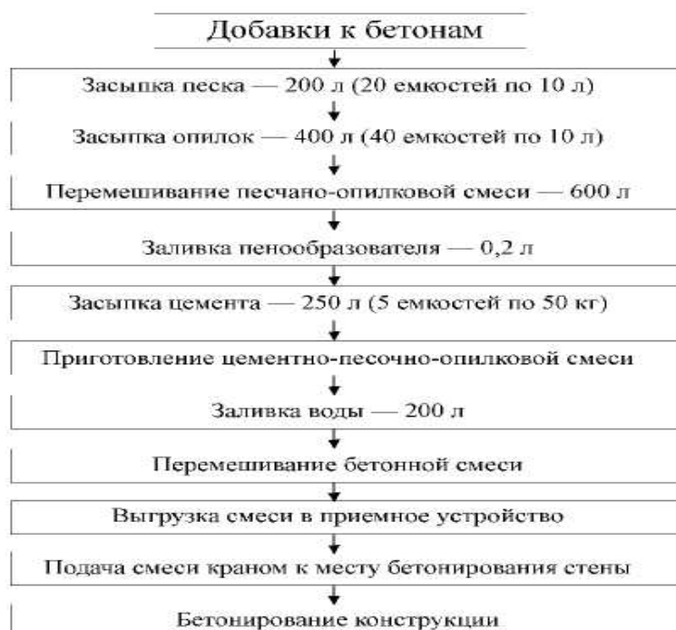
Рис. 25. Схема приготовления поризованного опилкобетона с двухэтапной закладкой строительных материалов (вариант №2)
