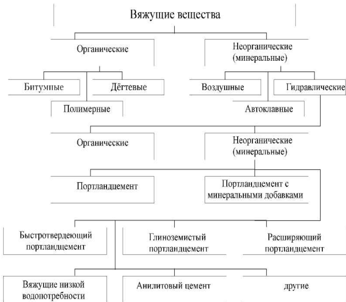
Рис. 11. Классификация вяжущих веществ для применения в строительстве малоэтажных домов
