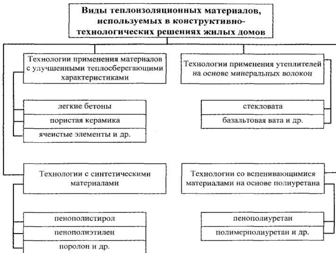
Рис. 2. Классификация основных технологий использования теплоизоляционных материалов в конструктивно-технологических решениях для жилых домов
