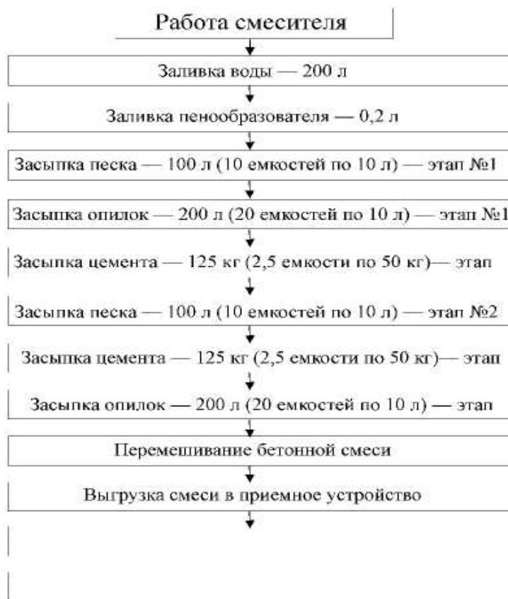
Рис. 25. Схема приготовления поризованного опилкобетона с двухэтапной закладкой строительных материалов (вариант №2)
