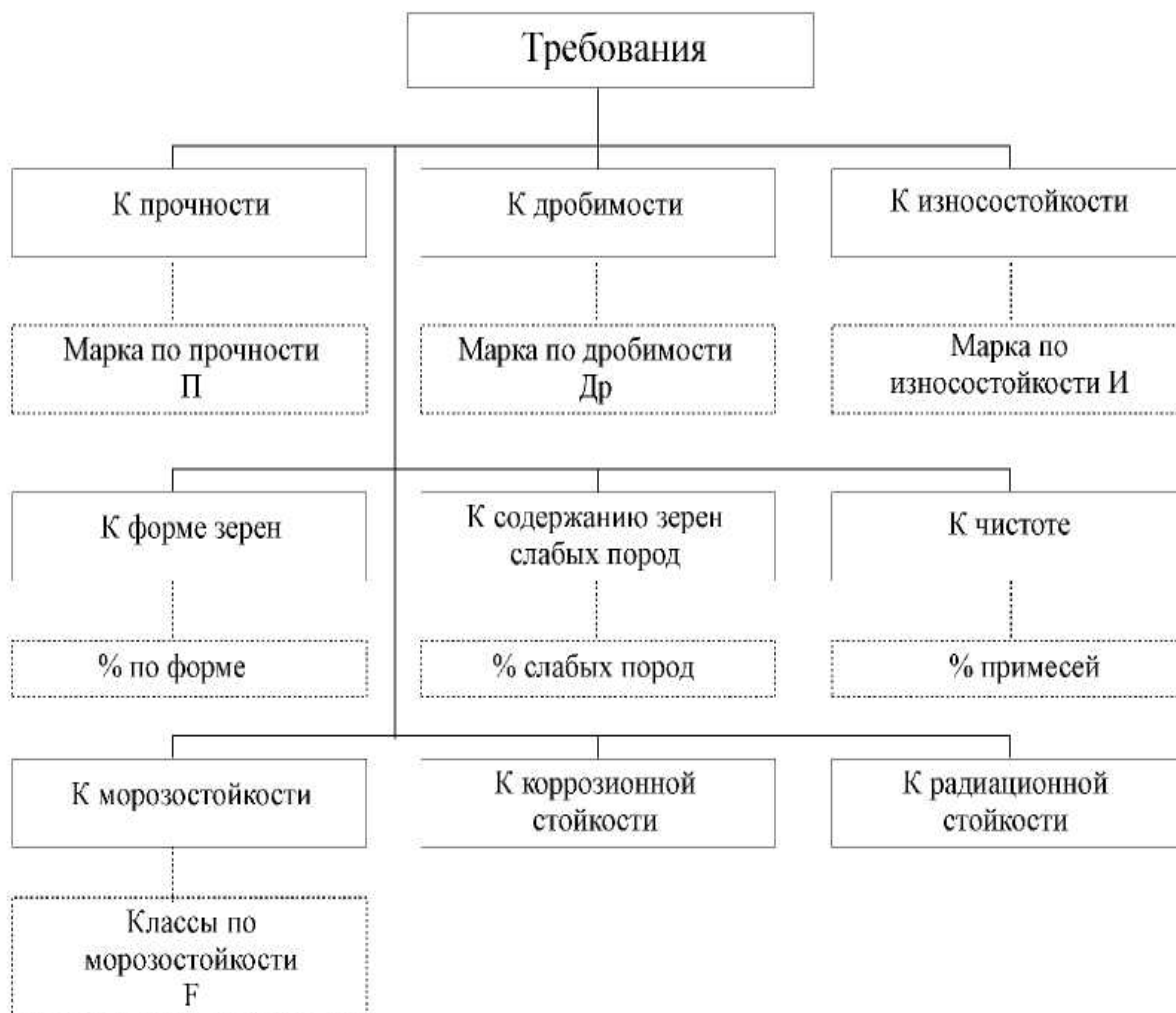
Рис. 16. Требования, предъявляемые к крупному заполнителю для аэрированных опилко- и перлитопесчаных бетонов
