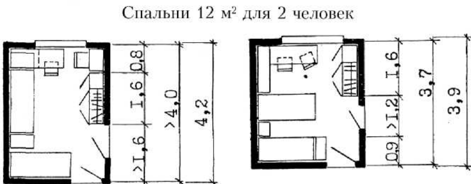
Рис.19. Функциональные габаритные схемы общих комнат и спален в жилых домах
