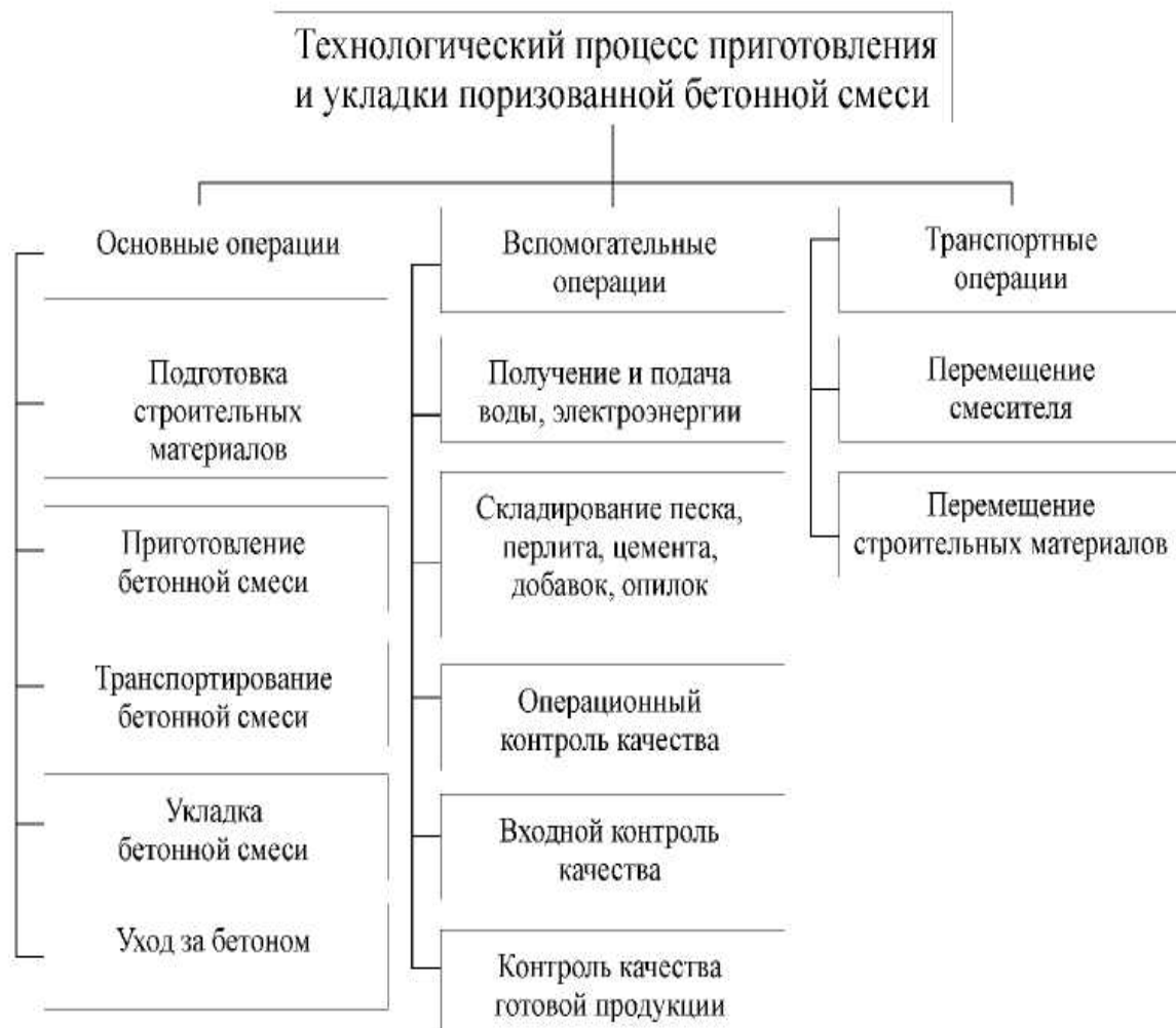
Рис. 26. Схема технологического процесса приготовления и укладки поризованной бетонной смеси в слоистых кирпичных стенах жилых домов
