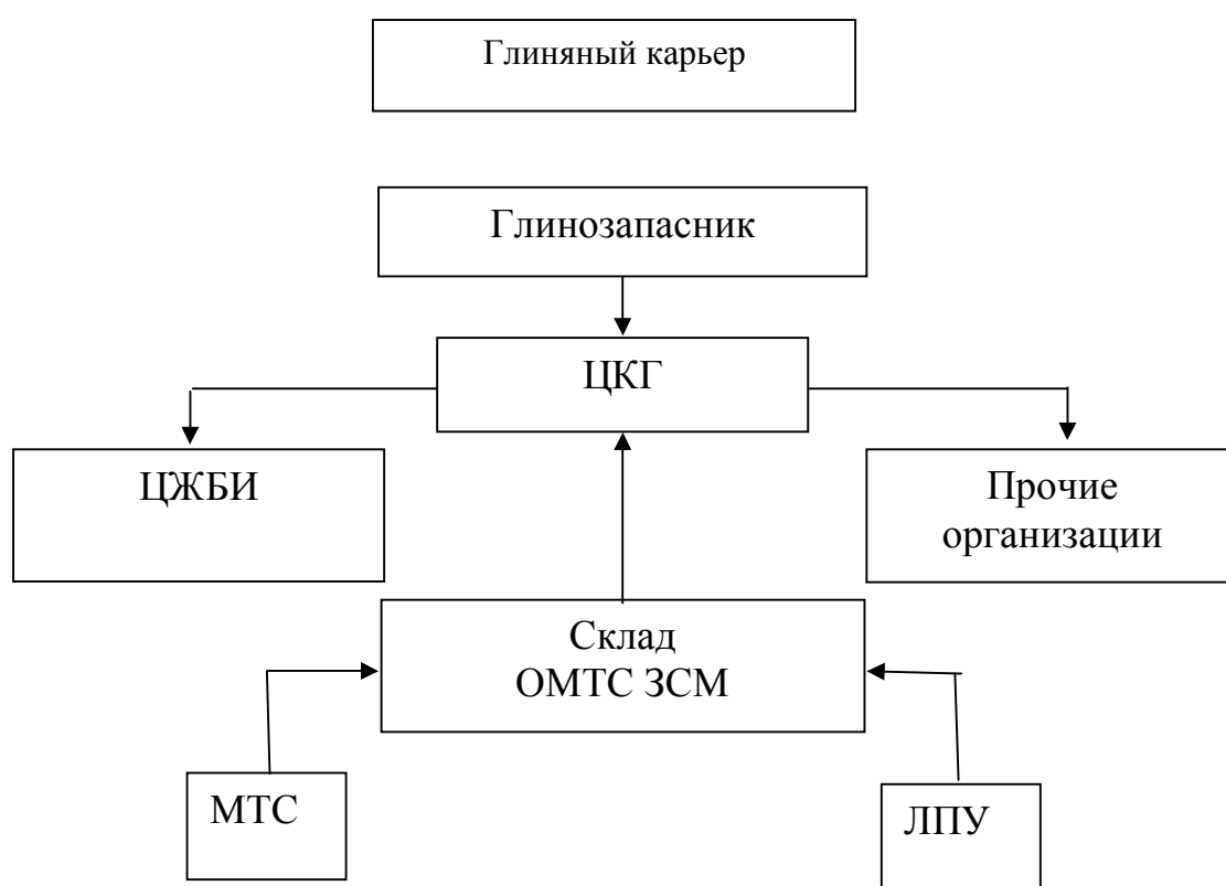
Рис. 3.11 – Технологическая схема цеха керамзитового гравия
